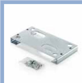
Plaque de fondation surélevée incluse. Fixation au sol entraxe 260 x 117, n.4 Ø 11, entraxe fixation moteur 300 x 75 n.4 M8
